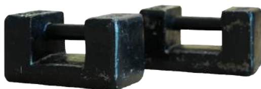
ตัวอย่าง ตุ่มน้ำหนักเหล็กมาตรฐาน น้ำหนัก 10 กิโลกรัม
