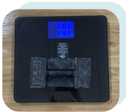
ตัวอย่าง การทดสอบความเที่ยงตรงเครื่องชั่งน้ำหนัก
