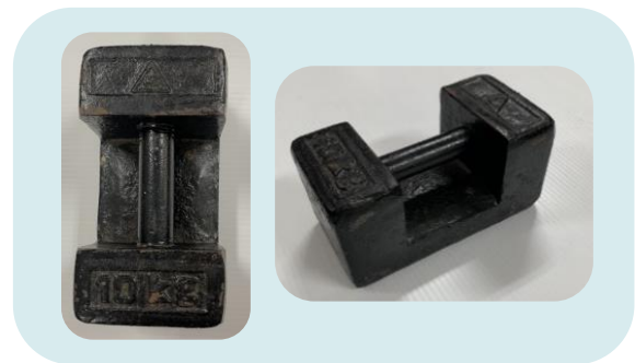
ตัวอย่าง ตุ้มน้ำหนักหลักมาตรฐาน น้ำหนัก 10 กิโลกรัม
