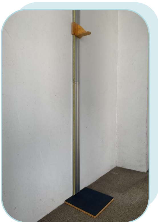
ติดกับผนังหรือเสาที่ไม่มีบัว ยึดให้แน่น ไม่โยกเยก ไม่เอียง
