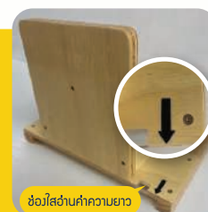
ตัวอย่าง เครื่องวัดความยาวเด็กต่ำกว่า 2 ปี ความละเอียด 0.1 เซนติเมตร ส่วนหัว สำหรับกั้นศีรษะเด็ก
