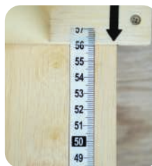
ตัวอย่าง เครื่องวัดความยาวเด็กต่ำกว่า 2 ปี ความละเอียด 0.1 เซนติเมตร ส่วนหัว สำหรับกั้นศีรษะเด็ก
