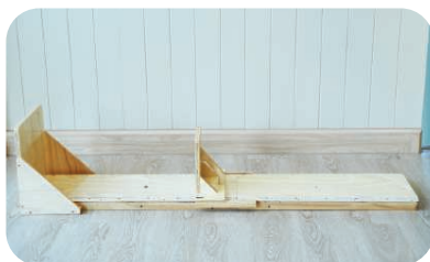
ตัวอย่าง เครื่องวัดความยาวเด็กต่ำกว่า 2 ปี ความละเอียด 0.1 เซนติเมตร ส่วนหัว สำหรับกั้นศีรษะเด็ก
